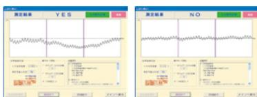
「心語り」の脳血流のデータ。「はい」(左)と「いいえ」(右)で血流が変わる。血流量を正確に測る光源、額に密着するセンサーの開発、血流量に加振動数を分析することで精度を向上。
